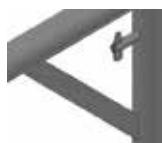
Refuerzo en extremos superiores mediante pasamano rectangular
