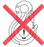
Gancho con excesivo desgaste de asentamiento
