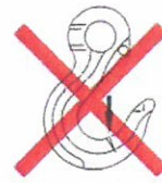
No usar ganchos con fisuras y sin pestillo de seguridad.
