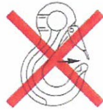
Gancho con excesiva deformación en apertura de boca
